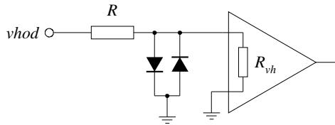
Zaradi eksponentne odvisnosti toka od napetosti na diodi, napetost na paru diod s sheme in na vhodu predajačevalca ne preseže  $\approx \pm 0.6V$ , če je električni tok dovolj omejen. Tok omejimo z zaščitnim uporom  $R$ . Pri izbiri le-tega upoštevamo še, da predstavlja zaščitni upor in vhodna upornost predajačevalca  $R_{vh}$  delilec napetosti. Zato je smiselno izbrati  $R < R_{vh}$ .
