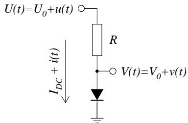
Napetost  $U(t)$  naj vsebuje poleg nekaj volтов velike enosmerne komponente  $U_0$  tudi majhno izmenično komponento  $u(t)$ . Tudi električni tok zapišemo kot vsoto enosmernega toka  $I_{DC}$  in majhnega izmeničnega toka  $i(t)$ . Diodno odvisnost napetosti od toka razvijemo v Taylorjevo vrsto okrog  $I_{DC}$  do linearnega člena:
