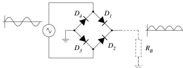
Ko je sinusni val pozitiven, teče električni tok iz vira skozi diodo D1 v breme in se vrača nazaj v vir skozi diodo D3. V negativnem delu vala teče električni tok skozi diodo D2 v breme in se vrača nazaj skozi diodo D4. V obeh primerih je smer toka skozi breme ista.
