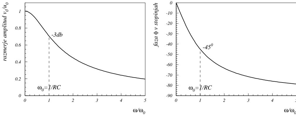
Graf  $\frac{v_0}{u_0}$  ponavadi rišemo v log-log skali. Če sta narisani le obe asimptoti (črtkano na sliki spodaj) se graf imenuje *Bodejev diagram*. Asimptoti se sekata pri frekvenci  $f_0$ .
