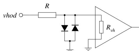
Zaradi eksponentne odvisnosti toka od napetosti na diodi, napetost na paru diod s sheme in na vhodu predajačevalca ne preseže  $\approx \pm 0.6V$ , če je električni tok dovolj omejen. Tok omejimo z zaščitnim uporom  $R$ . Pri izbiri le-tega upoštevamo še, da predstavlja zaščitni upor in vhodna upornost predajačevalca  $R_{vh}$  delilc napetosti. Zato je smiselno izbrati  $R < R_{vh}$ .
