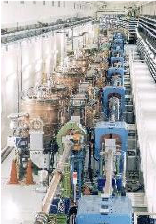
Del obroča trkalnika: magneti in pospeševalni elementi
